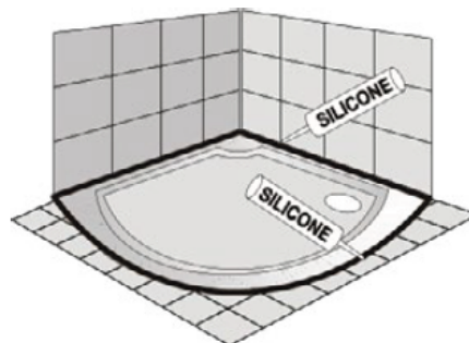
Zapustená do podlahy
