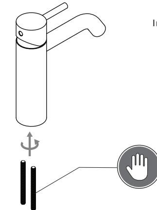
**4) Nasadte gumové těsnění a kovovou podložku upevňovací sady. Poté našroubujte matice na závitové tyče a dotáhněte je klíčem.**
