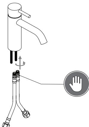
**3) Podložku a o-kroužek nasuňte přes pívodní flexibilní hadice a poté celou sestavu (flexibilní hadice a závitové tyče) vložte do otvoru v umyvadle nebo bidetu (dle modelu baterie).**
