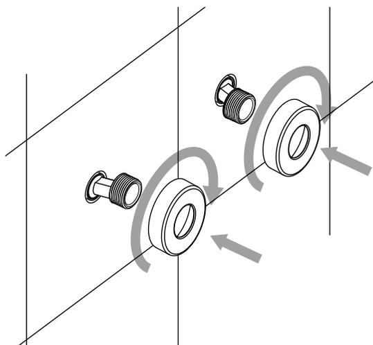
**3) Baterii připevněte na přívod vody, nezapomeňte vložit těsnění (3/4" závit). Matice pak dotáhněte klíčem.**
