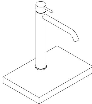
**2) Našroubujte přívodní flexibilní hadice do otvorů pro vstup vody ve spodní části těla baterie a dotáhněte je rukou.**
